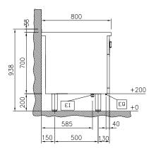
Electrical inlet (power) Equipotential screw
